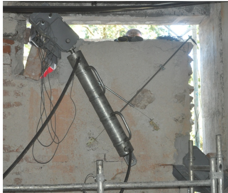
N° 4 trasduttori induttivi di spostamento Trasduttore di pressione a ponte intero N° 2 martinetti da 150kN Acquisizione centralina HBM UPM 60
